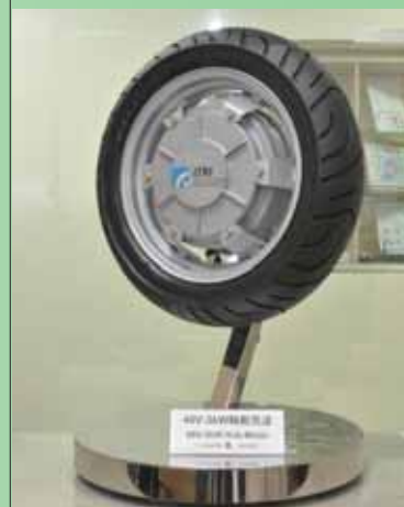
電動車搭載工研院研發的輪轂馬達系統，可省去傳動系統，對於空間要求嚴苛的電動車有著極大優勢。
