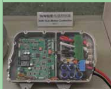
能夠承受高溫、高電壓的超高效率輪轂馬達控制器，是工研院機械所智慧車輛技術組針對電動車的發展重點。
