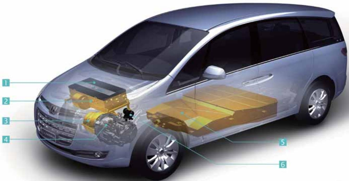
1 Power Electronic Unit [PEU] (電能動力控制器) 2 EV System Control Relay Box (電動車系統控制繼電器盒) 3 Traction Induction Motor (電動感應馬達)
