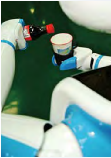
Eye to Motion視覺伺服控制技術的應用，可以驅使服務型機器人一手夾取圓弧的飲料瓶，平穩地移往另一手的杯子上方，將可樂盛滿杯子而不外溢。
