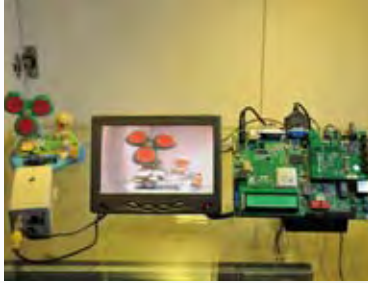
人如果要用手去拿東西，會配合雙眼了解物體的距離，然後控制手臂去協調；嵌入式即時系統物體追蹤模組就運用相同的道理，幫助機器人達到手眼協調。
