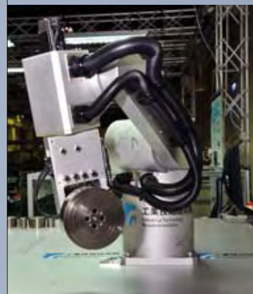
產業用機器人在工廠內負責焊接、組裝、搬運、包裝等重要工作，必須承受得起很大的負載重量，此具機器手臂完全由工研院開發，目前正在做重量測試。
