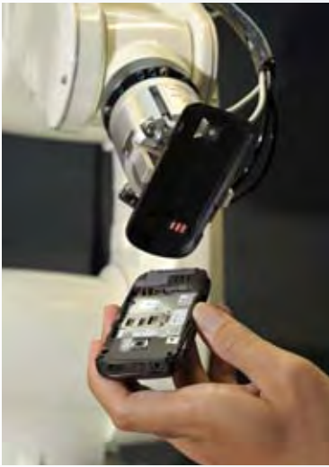
透過Eye to Motion視覺伺服控制技術，未來機器人能夠快速理解工作內容並投入生產，形成「人機共存」的作業模式。
