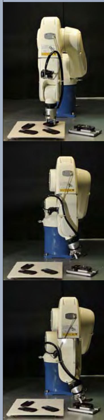
從連續動作可以看出，經視覺影像的辨識運算後，驅動機器手臂抓取隨意放置的手機背蓋，並自動移至待組裝的手機上，精準完成組裝的動作。
