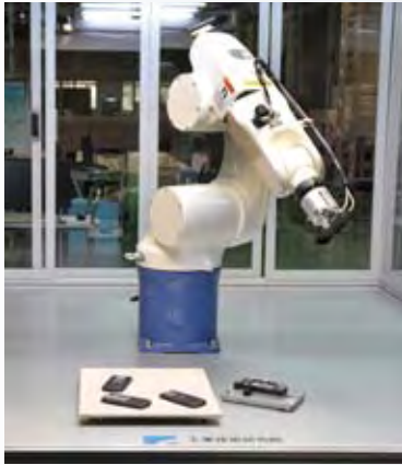
透過視覺即時引導控制機器手臂進行夾持組裝，組裝零件可隨機分散放置，解決整列作業、降低前置作業時間，也可減少夾治具需求，縮短路徑教導時間。
