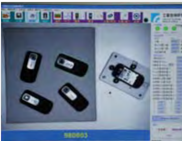
有了定位系統程式，即使物件隨意放置，機器手臂仍有辦法以最短的時間，判斷出精確的抓取位置。
