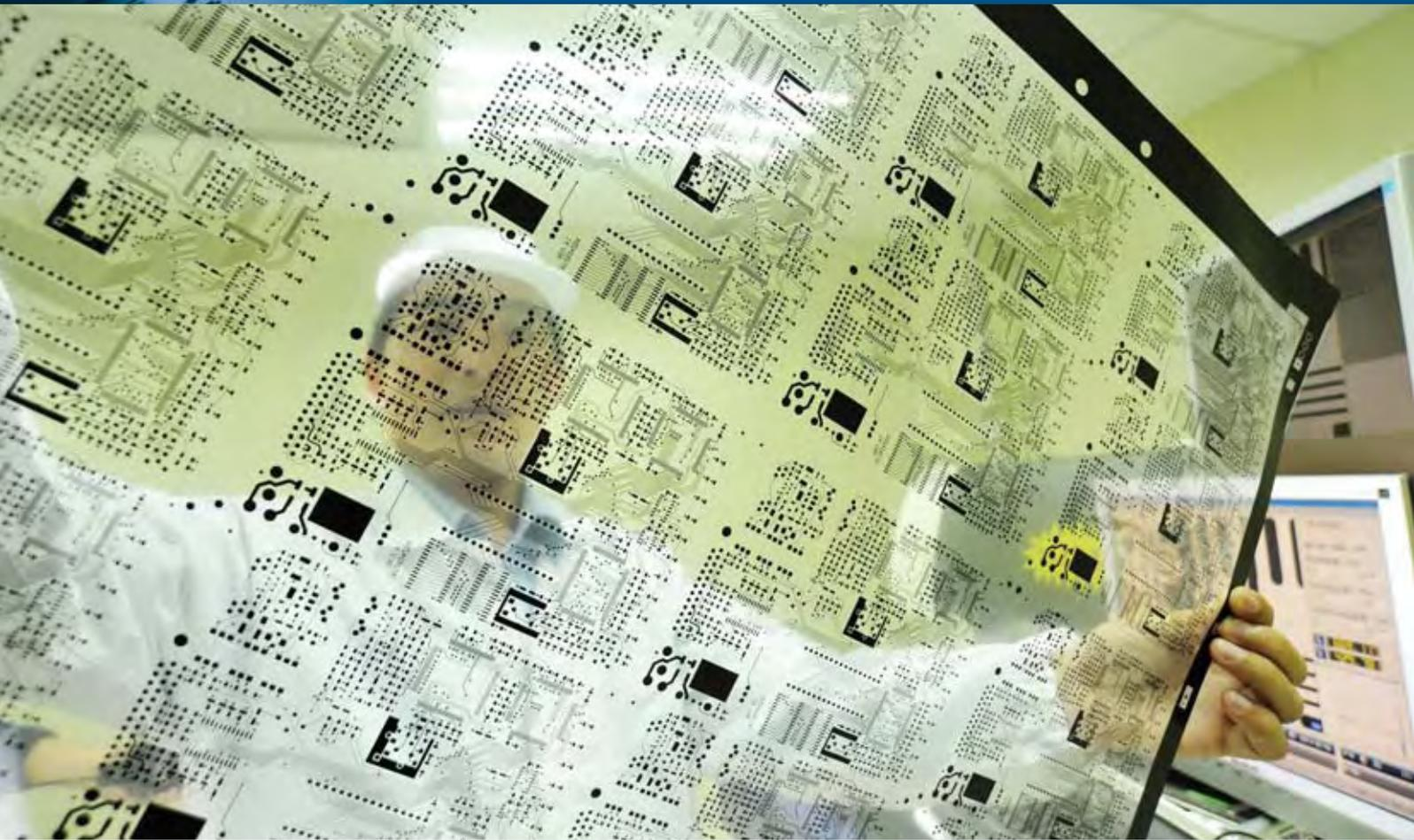
PCB底片在進行蝕刻製板前，需先進行品質檢測，一發現有斷線、突出、髒點等瑕疵，就得補強甚或放棄不用。
