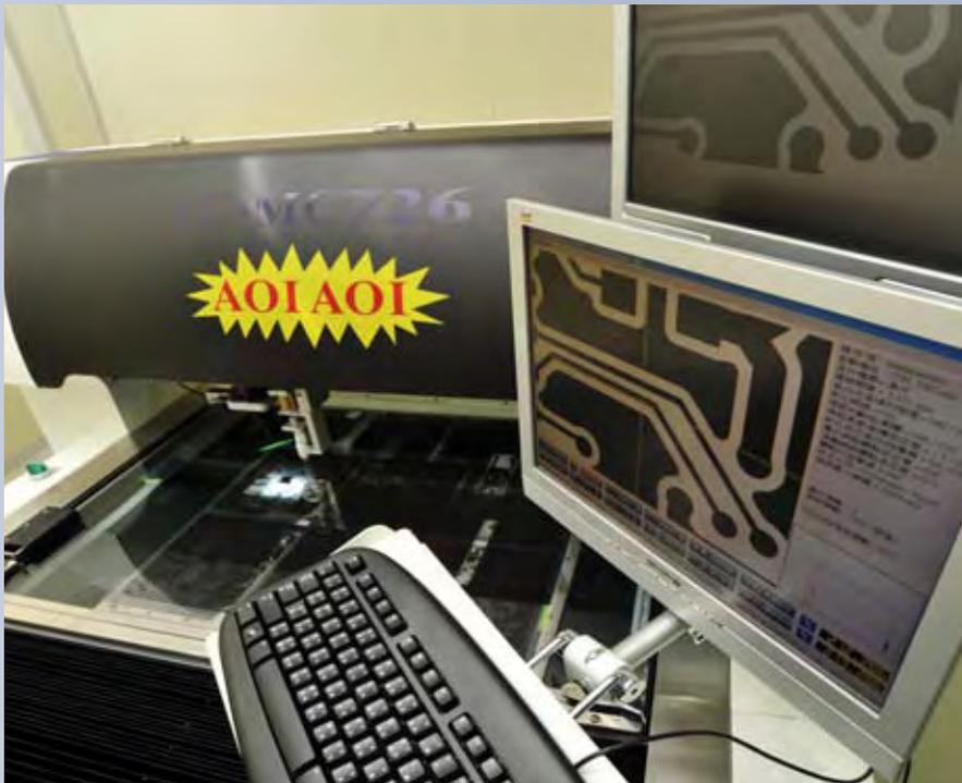
詠加的高速底片檢測機，結合了工研院新研發的技術，採用最新高速視覺檢查系統、最新比對方式及CAM資料格式，可演算檢測底片的各類瑕疵。
