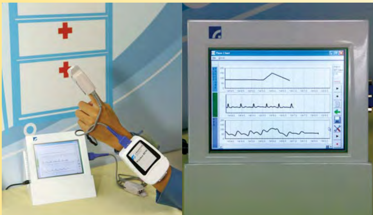
「居家睡眠檢測儀」使用簡單，只需將脈動血氧計感測器夾在手指上超過6小時，儀器就能記錄睡眠時的狀況，隔天再將資料提供給醫院進行分析，發揮定點照護功效。
