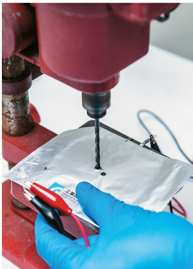
鋁離子電池可彎折且體積輕薄短小，即使遭受到外力穿刺，亦不需擔心發生爆炸。
