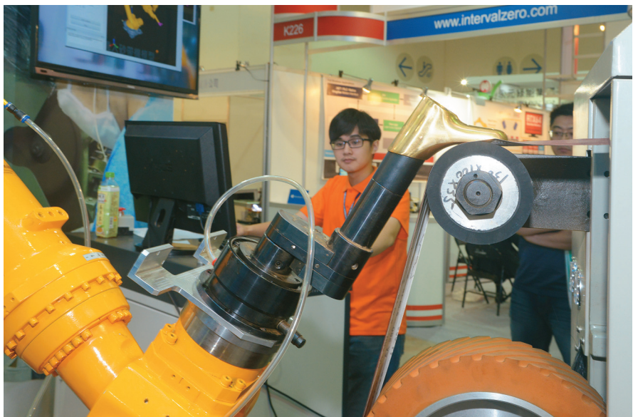
CPS 研磨拋光機器人能應用於水五金產業中，預計可縮短將近 60% 的零件打磨時間。
