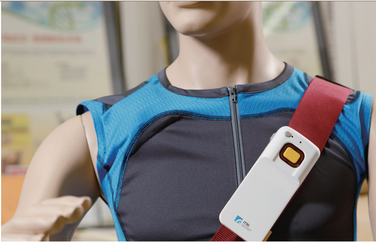
NPNS 的微型雷達技術可隔著衣服進行感測，不受裝置的佩戴形式或是外在的電訊號或光雜訊影響。
