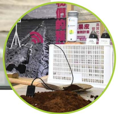
作物病害精準預警系統以感測技術監控氣候及土壤環境，預測洋蔥感染炭疽菌的準確度高。
