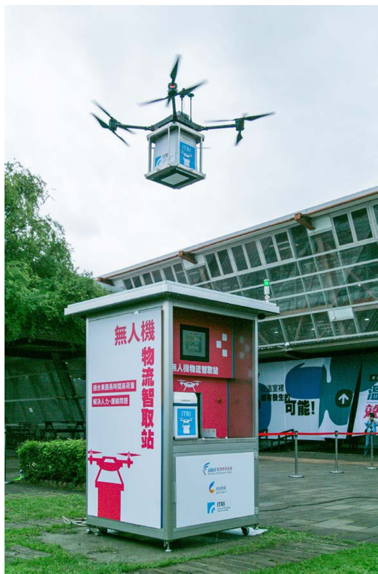
無人機與智取站透過訊號溝通靠下貨，物件自動入庫待取，中間無須人力經手。
