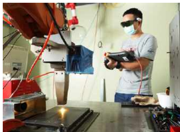
雷射銲接具有加工光點小、能量集中、銲速快等特性，不僅能加快生產速度，也可兼顧品質，引起一股雷射銲接旋風。
