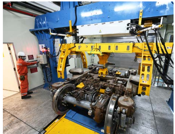
工研院打造的「轉向架走行測試設備」通過歐盟「產品安全認證」，可應用在各種軌道運具維修測試，更可望行銷國際！
