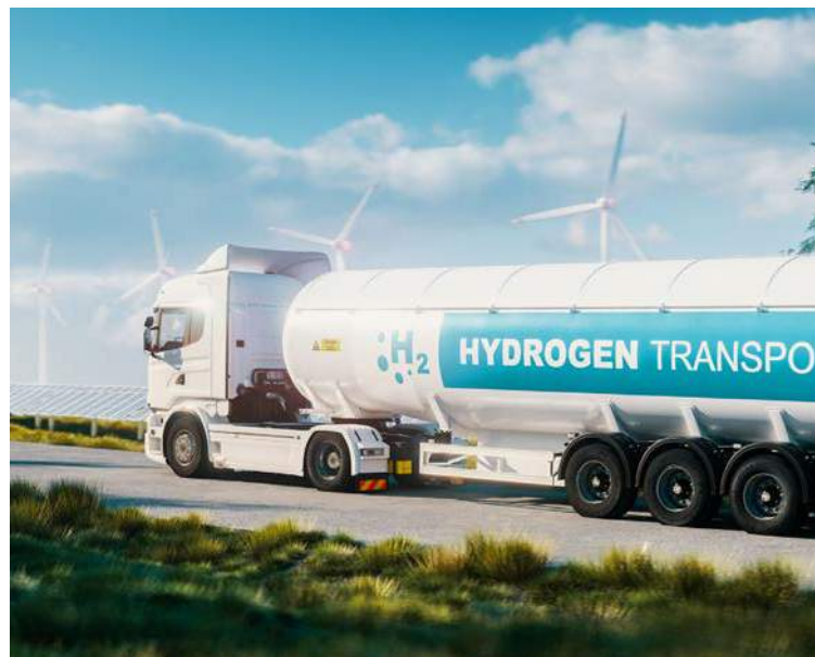
氫液化後體積會比氣態時小近1,000倍，載送量更多，因此長途運輸均採用液化氫形式。
