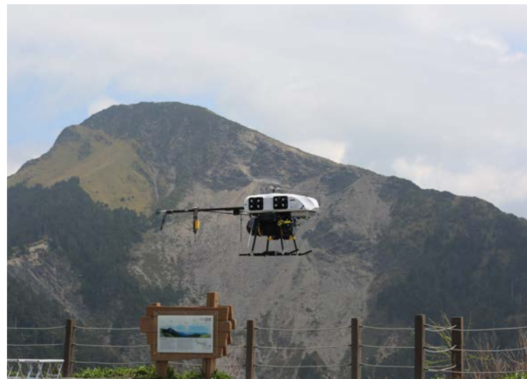
工研院開發燃料電池無人機已成功完成一系列跨海及高山救援驗證，並創下雙軸旋翼機酬載10公斤飛行126分鐘等多項優異長航時紀錄。
