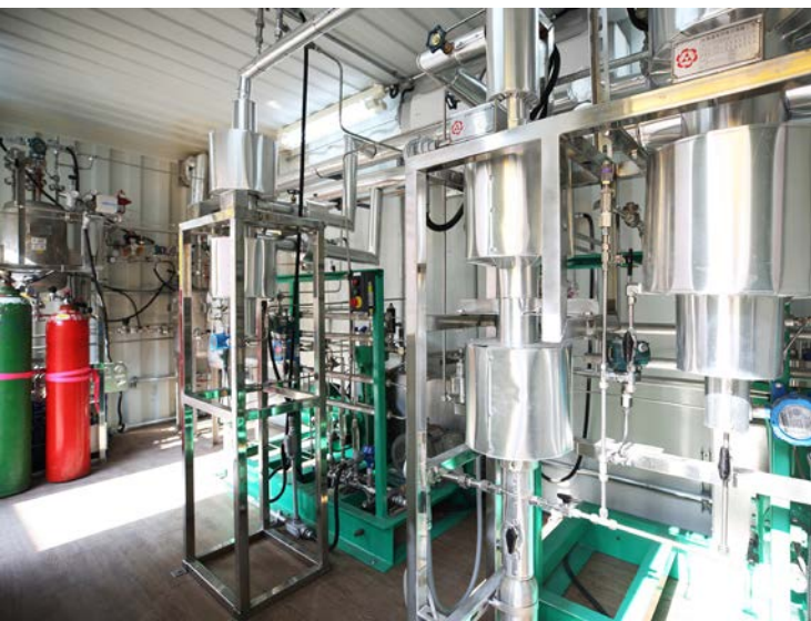
工研院以自主研發的鎳、銅、鋅等合金為觸媒，結合氫氣及適當溫度，將CO及CO 2 轉為甲醇及甲烷，成為低碳再生料源。
