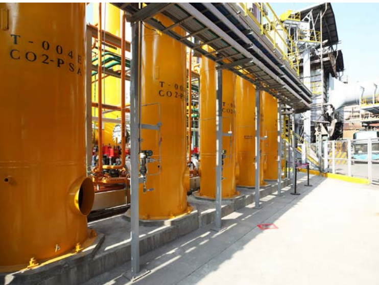
壓縮機將氣體打入內有吸附劑可吸附二氧化碳及一氧化碳的塔槽，捕獲廢氣中的一氧化碳及二氧化碳。
