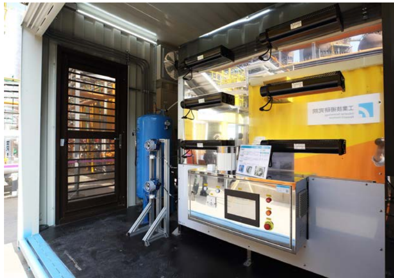
工研院開發的純化設備，以獨家多孔真空纖維膜捕獲技術，將CO 2 濃度可再進一步提升至99%。
