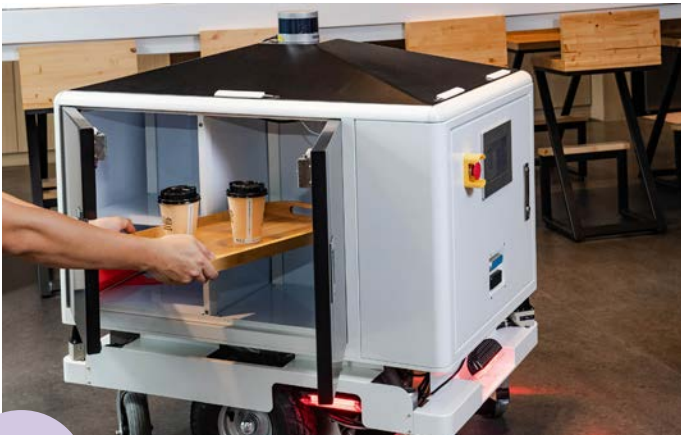
工研院研發「室內外自主移動載具Cubot ONE」，結合5G、AIoT、V2X、AMR，首創送餐到府的應用服務，可在室內外自由移動，還能搭電梯跨樓層配送，已串聯統一集團外送平台foodomo進行場域實證。
