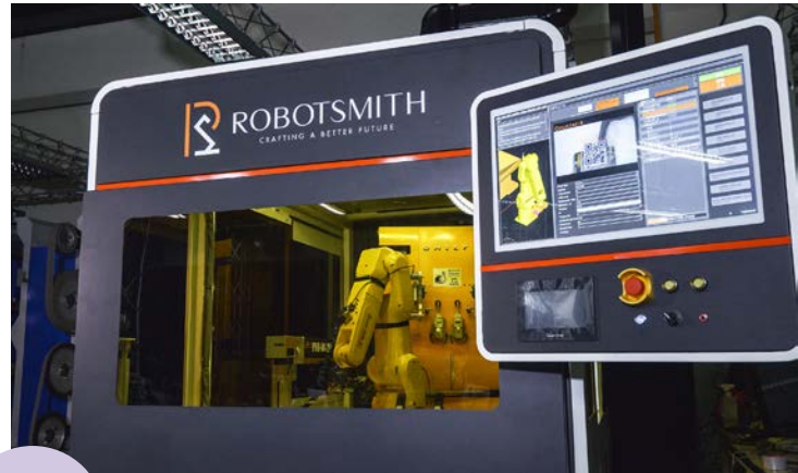
「機器人史密斯」以AI軟體技術克服製程瓶頸，透過虛實整合於線上修正研磨拋光路徑，已應用於水五金、廚具、醫材人工關節等拋光研磨，開啟人機協作新時代。
