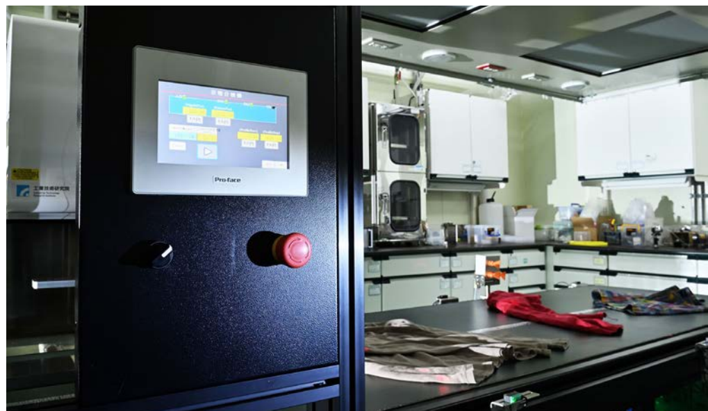
工研院的織物回收用纖維分選器提升「拉曼光譜」的效率，可達到1秒辨識一件衣服的速度，穩定又不受衣服顏色干擾，辨識聚酯纖維的精準度可達95%。
