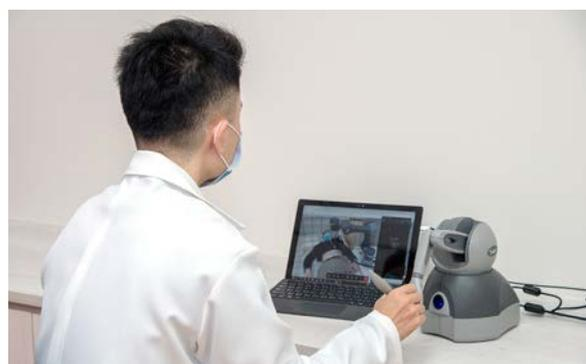
遠距超音波診察主要分為醫師端與病人端兩部分，醫師端可直接操作3D力回饋搖桿，遠端遙控病人端的機械手臂動作；機械手臂則配置無線超音波探頭，並整合壓力與距離感測器，進行有效且安全的超音波診察。
