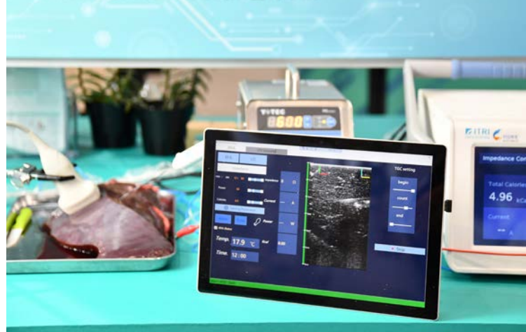
工研院開發出「智慧腫瘤射頻熱消融系統」是全球第一台單機整合超音波影像、微創手術、演算法的射頻熱消融系統，已完成技術轉移。
