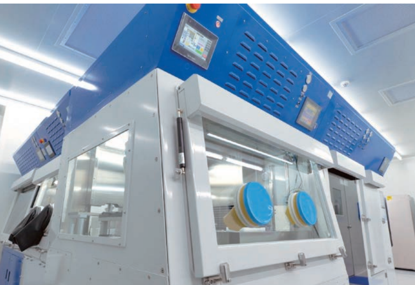
工研院開發出的臺灣第一座MIT貼附型細胞自動化生產系統，結合機械手臂，可客製化搭配不同模組打造出專屬設備。
