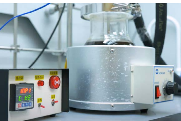
工研院運用綠色無菌製程、低溫勻相生質輔助萃取、氧化抑制活性保存等關鍵技術，開發出可在低溫、極短時間內萃取出具有抑菌效果的高濃度多酚、高抗氧化效果的GravaLift。
