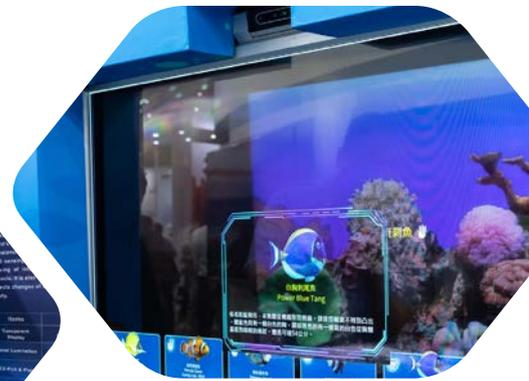
全球首創「高透明顯示系統」，採用透明投影虛實融合技術，可在透明顯示螢幕上顯示魚種資訊，且支援非接觸式手勢辨識。
