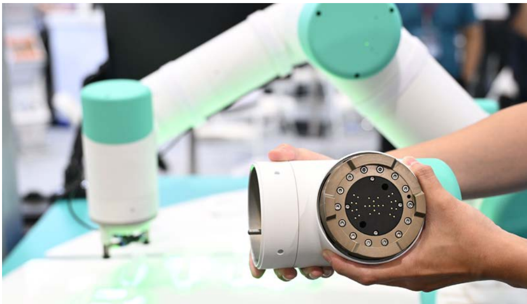
「快速組裝關節機器人」可配合少量多樣、彈性產線需求，快速調整機器人型態及產線配置，僅一款式就能組裝出不同類型的機械手臂。
