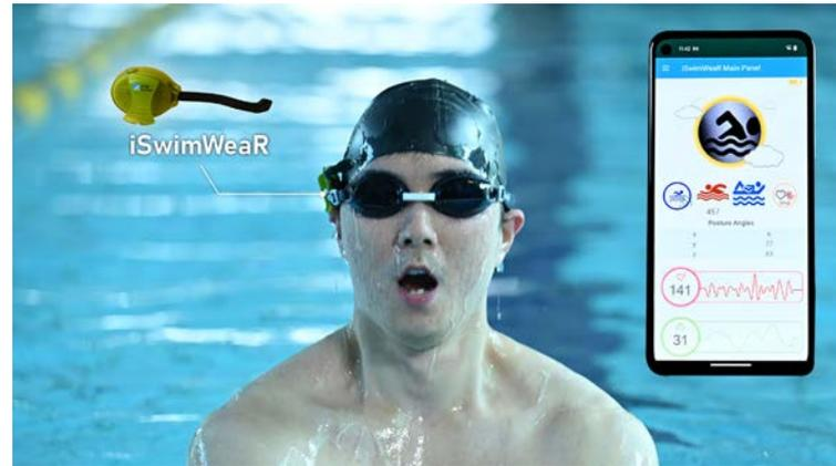
「智慧潛鏡」具備隱形感知功能，不須直接接觸皮膚，只要將裝置安裝於既有的泳鏡、潛水面罩上，即可輕鬆分析使用者的水中運動數據。
