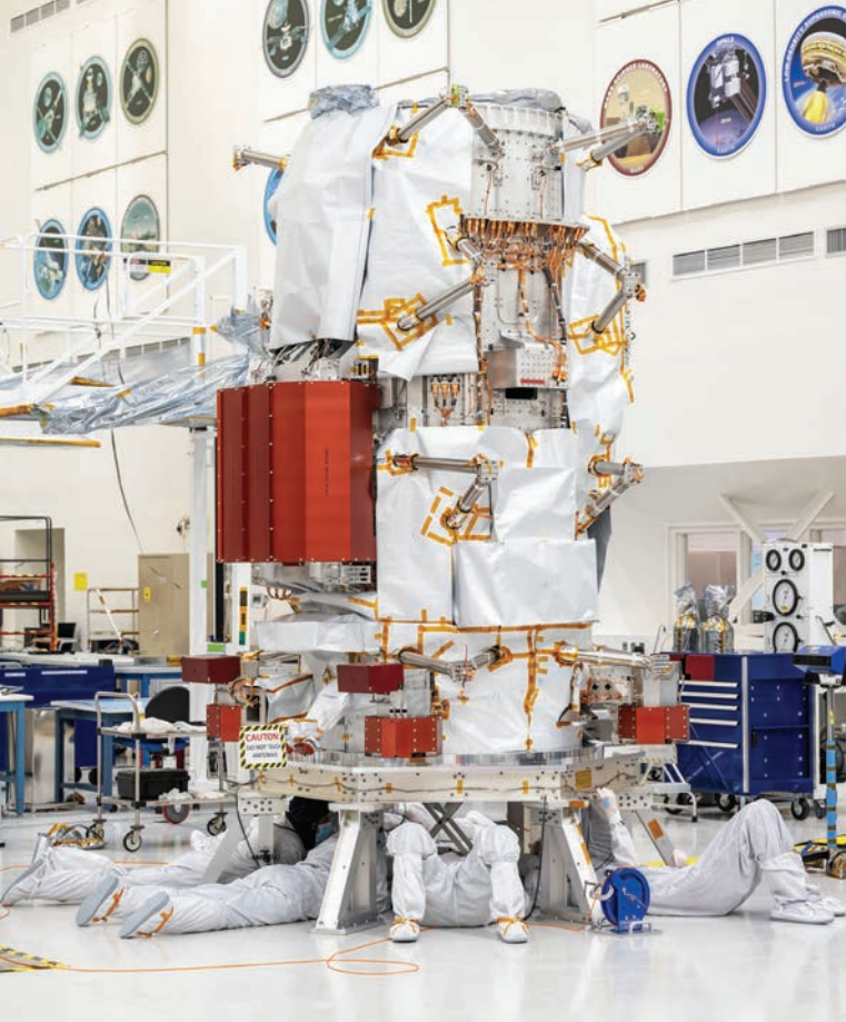
↑ 在加州美國太空總署噴射推進實驗室裡，工程與技術人員安裝歐羅巴快艇號的反動輪。
