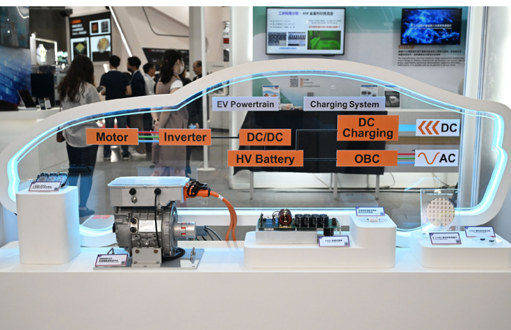
相比傳統以矽基半導體為主的功率元件，碳化矽具備高效率、高耐壓、高溫穩定性等優勢，是電能轉換效率提升的關鍵。
