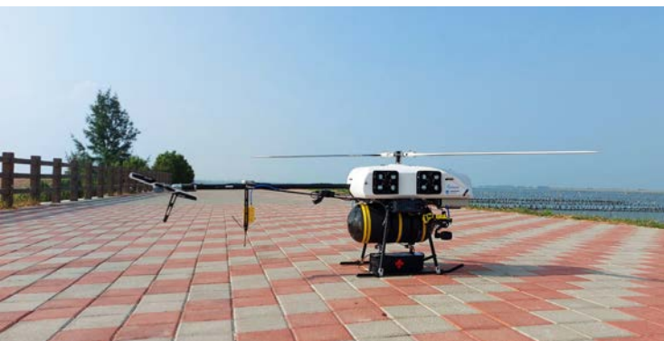
氫燃料電池無人機已於高山、跨海及長航時等一系列實際驗證，不斷突破業界飛行紀錄。
