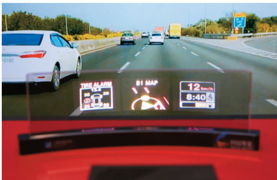
遠距浮空多屏抬頭顯示器是工研院在自駕車的關鍵元件技術之一，疊合導航、行車紀錄器及車子的運動，投影於車窗玻璃，透過路況資訊的融合做為導航的依據，讓行車更安全。
