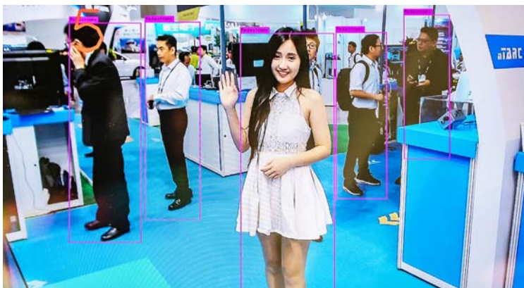
「智慧定點裝置人流偵測系統」透過攝影機，偵測公車站候車乘客的即時狀況，並將人流偵測結果傳輸至後端平台，作為日後車輛調派班次的安排參考。
