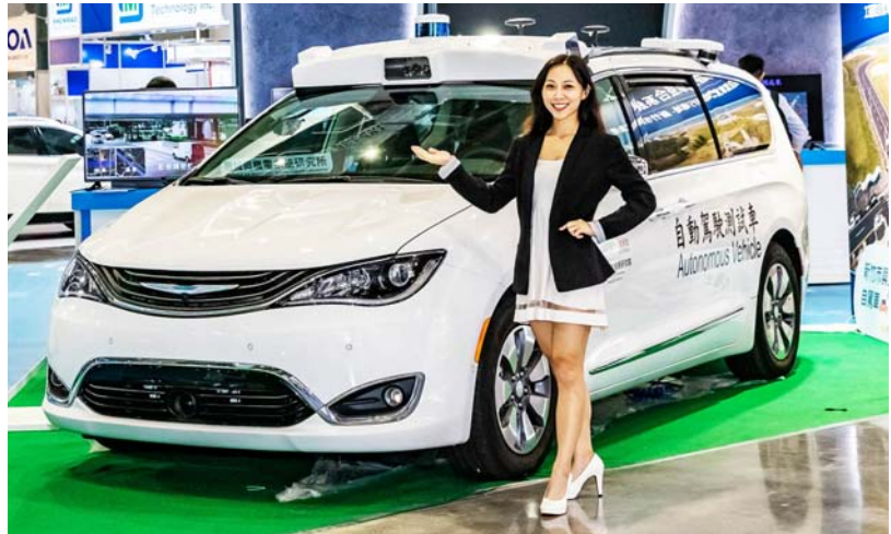
「全天候多車型自駕車整合系統」即使在室內、隧道衛星訊號微弱的地方，依然能自動駕駛、自動停車，自駕功能已達國際定義的「Level 4」等級。
