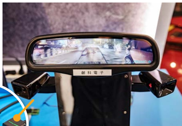
電子式後視鏡搭載了AI深度學習系統，開發出獨家的「全天候障礙物偵測功能」，等於為車輛安裝了大腦與眼睛。
