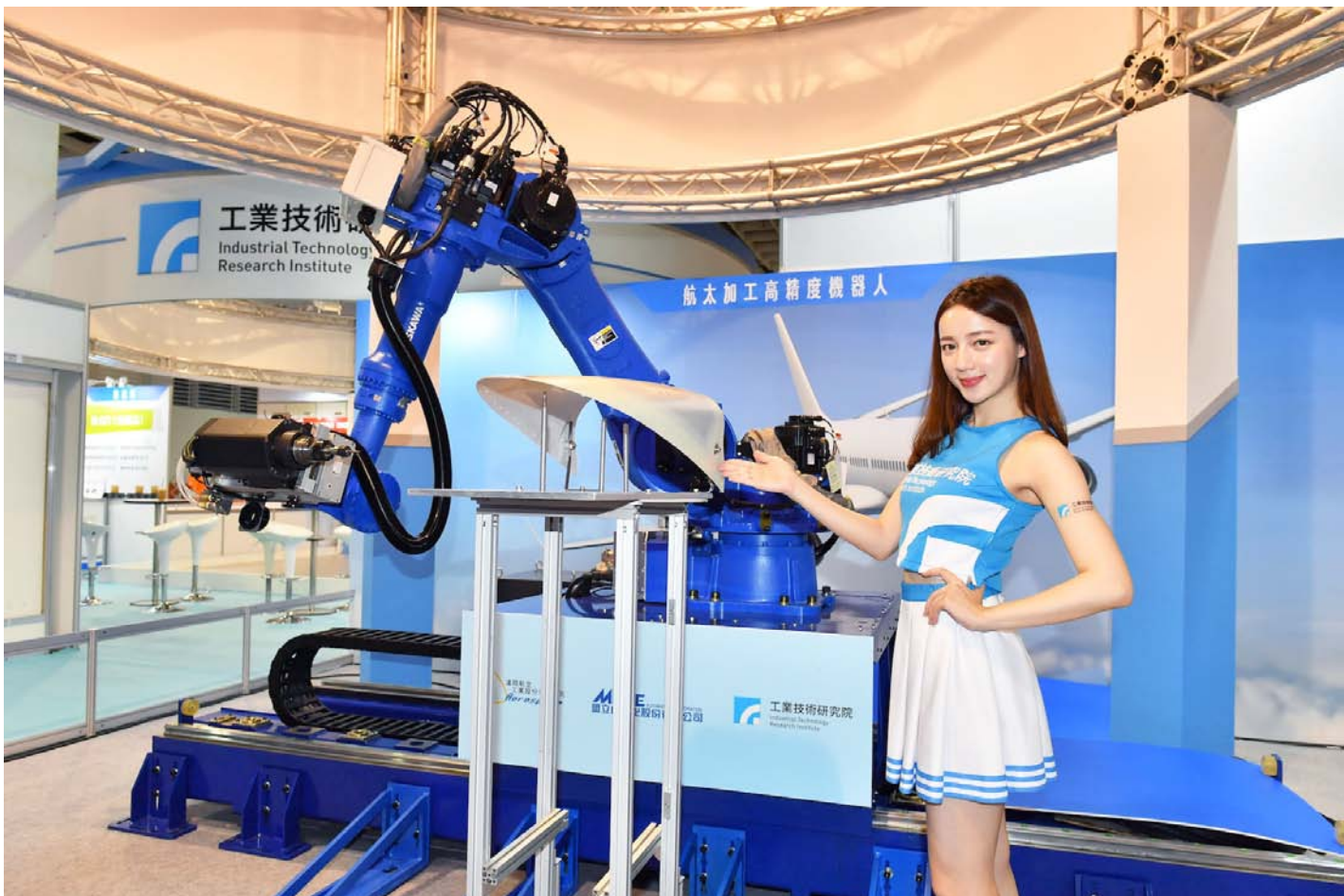
「航太加工高精度機器人」採用「eMIO」機器人控制器平台，機器手臂規模小型化，與國外機器人加工系統相比，成本至少下降50%以上。
