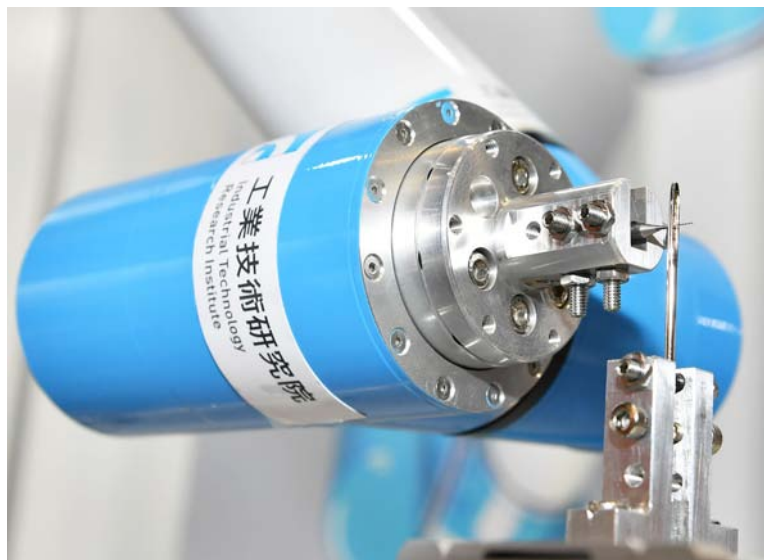
「高荷重比驅控整合協作型手臂」，集高精度、輕量化、模組化、驅控四大優勢於一身，±0.02mm的重複精度，可做到穿針引線動作，優於國際上協作型手臂9倍。
