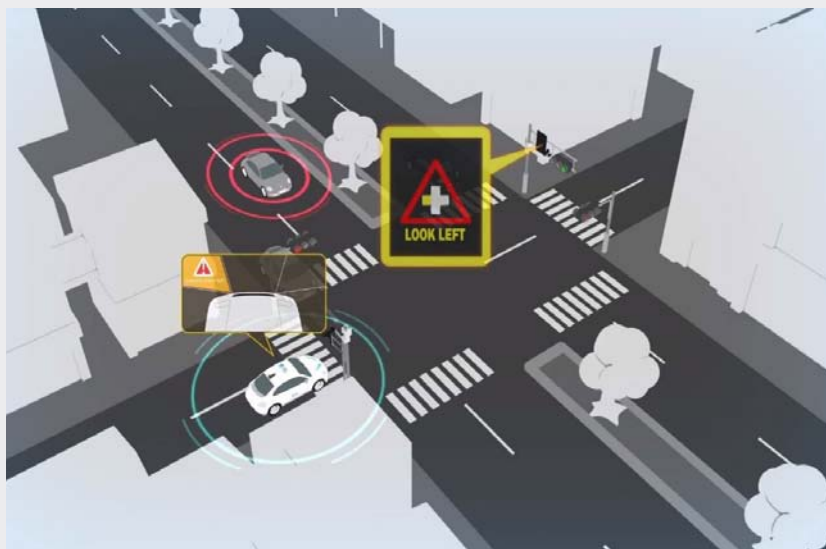
汽車雷達常因路口建築物或其他車輛造成偵測盲點，因此必須仰賴路上的雷達或光達感測器站在制高點以偵測路口動態，擴充駕駛者的可防護範圍。
