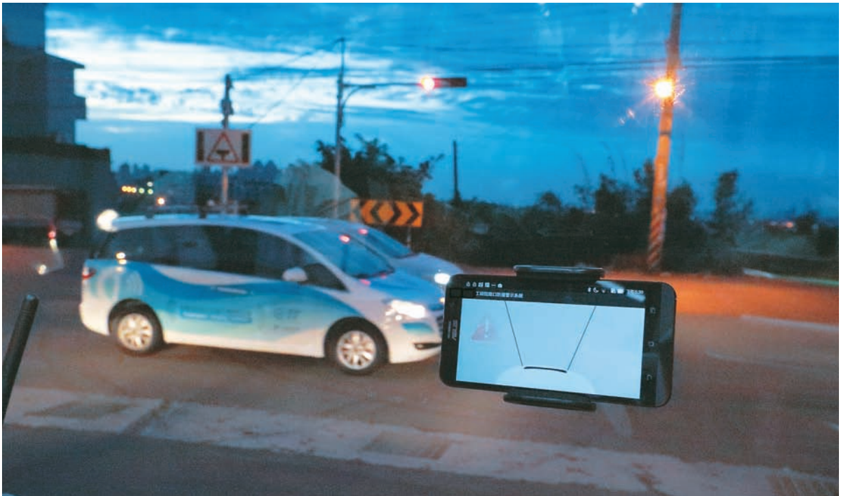
工研院研發的「iRoadSafe」整合通訊、感測器與交通號誌、設施等資訊，破除視覺盲點障礙，並傳輸到電子看板，提醒用路人達到安全防撞效果。
