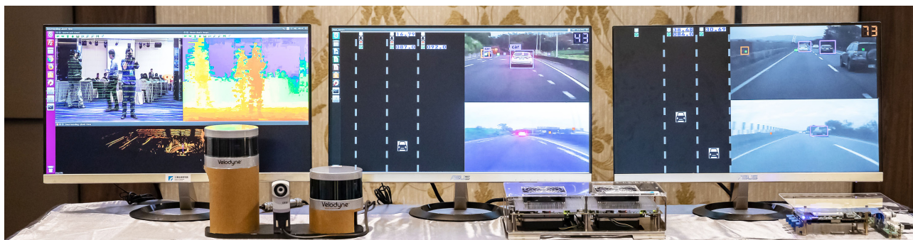
工研院研發多重感測融合平台，將光達、雷達、攝影機等異質感測器，整合於自動駕駛輔助系統，進一步提升影像辨識能力，就算在夜晚、大霧等天候環境裡，也可以針對各種狀況做出立即又正確的反應。
