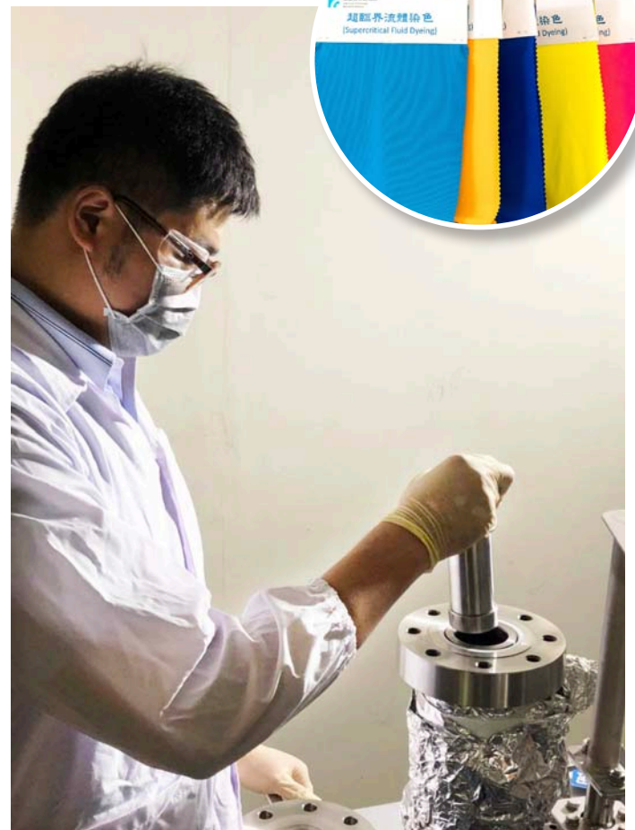
將布料放入特製鋼爐中，4小時後打開爐門，一卷捲聚酯纖維與彈性布料已經染上亮麗的色彩，染色過程中不用一滴水，還能同時賦予布料如吸濕排汗等機能。
