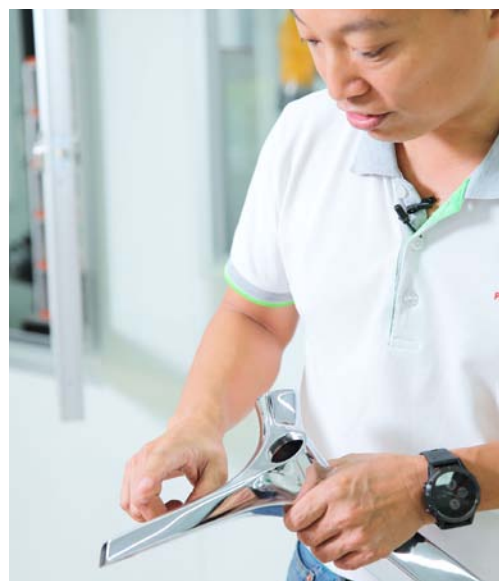
滿益金科技總經理張家烈用生產難度極高的水龍頭來讓機器手臂研磨，研磨覆蓋率可達80%以上，且線條更有型，勝過人工研磨。
