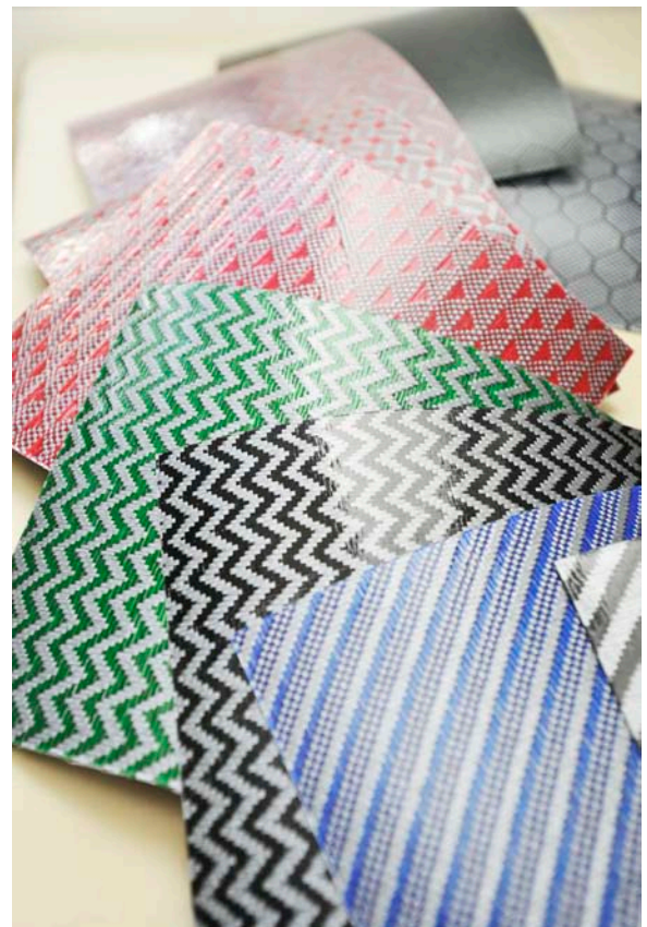
工研院與鑫永銓合作，將熱塑性碳纖維複材（右圖）混紡編織，製成質地輕、剛性強韌的行李箱，即使重壓踩踏也不會脆裂，待壓力消失後，即可回彈恢復原形。（左圖）
