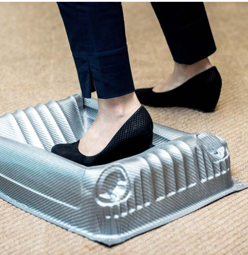
工研院與鑫永銓合作，將熱塑性碳纖維複材（右圖）混紡編織，製成質地輕、剛性強韌的行李箱，即使重壓踩踏也不會脆裂，待壓力消失後，即可回彈恢復原形。（左圖）
