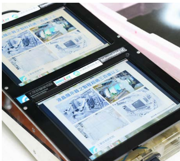
利用「廢液晶面板再利用處理系統」萃取出來的液晶所做出來的顯示器色彩效果，與市面成品相比不分上下。
