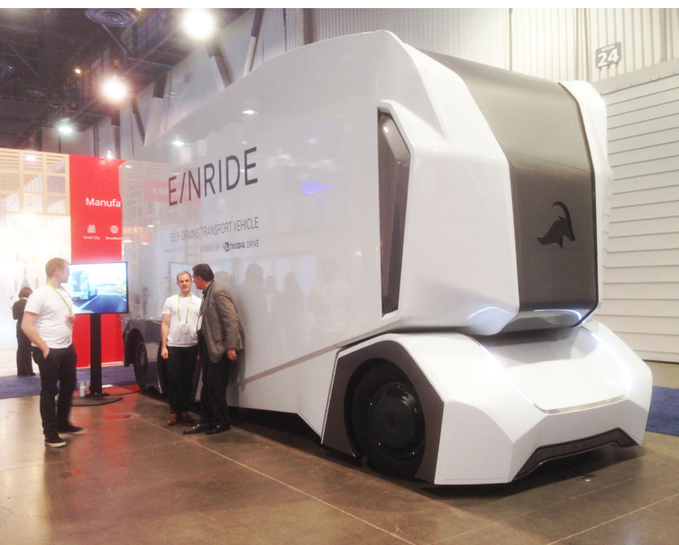
瑞典E/NRIDE推出電動伐木卡車T-Log，將駕駛座取消、車體裝備與內裝重新設計，以應用大型貨物的運送。（謝駿璘提供）
