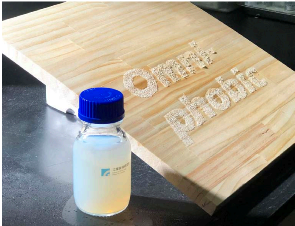
「水性奈米抗塵防污塗料」具有撥水、防污功能，未經塗料塗布處（圖中字母圖案），極容易沾染粉塵。
