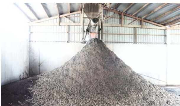
禽畜糞廢棄物可透過高效厭氧發酵技術，將其中的有機物質大量轉換為沼氣，氮與磷則存留於沼渣以及沼液中。圖為經過厭氧發酵、脫水後的沼渣原料。
