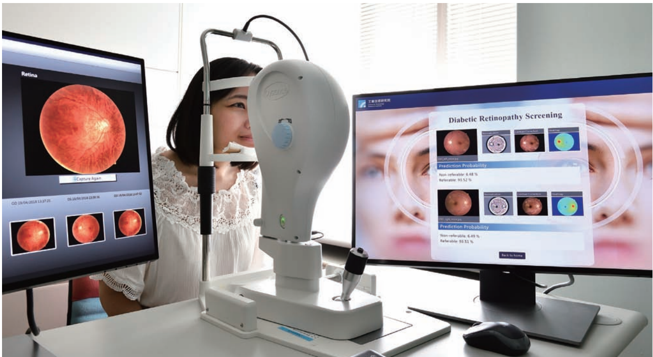
「糖尿病視網膜病變分析技術」藉由AI判讀系統可以標示出主要病徵位置，並提供病變分級資訊，有效協助第一線非眼科醫師進行精確診斷。
