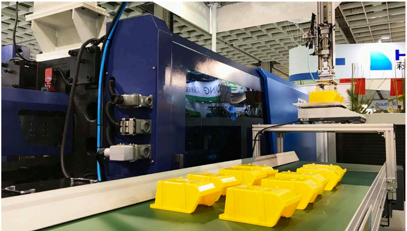
富強鑫與工研院合作開發的「智慧感測成型平台」協助塑膠射出產業邁向工業4.0。（富強鑫提供）
