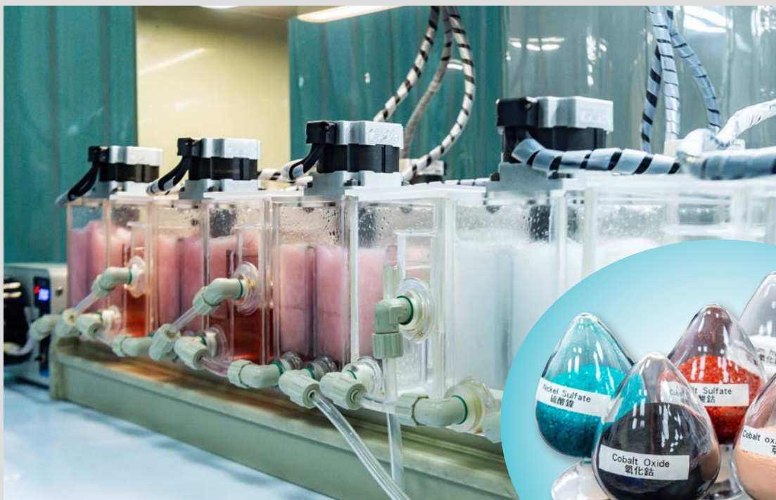
工研院投入鋰電池的循環技術，2020年開始建置小型濕法處理設備，萃取獲得的有價金屬可導入電池或其他產業的再利用。
