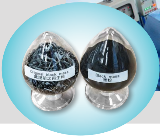
將電池外殼剝離後進行粉碎，浮選出塑膠原料等較輕的物質，再以磁選將不同金屬材料加以分類。
