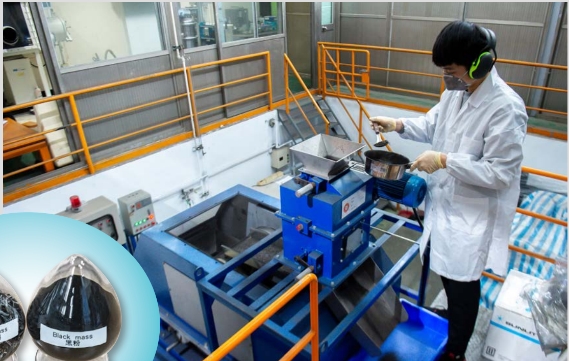
將電池外殼剝離後進行粉碎，浮選出塑膠原料等較輕的物質，再以磁選將不同金屬材料加以分類。
