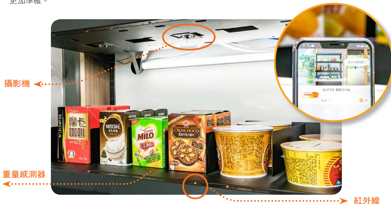
易取智慧貨架裝設紅外線、攝影機與重量感測器，精準辨識所拿取的商品種類與數量，即時顯示在手機APP上。
