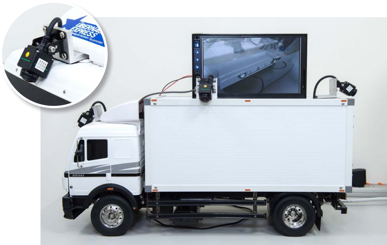
創科電子致力於開發車輛的「視覺輔助系統」，透過影像感測器，精準計算出車輛與物體之間的相對關係，進而發出警示，就像幫車子裝上一雙「眼睛」。
