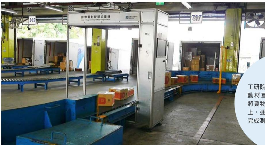
工研院打造動靜皆宜的「自動材重辨識系統」，只需將貨物放在高速運行輸送帶上，通過量測關口就能即時完成測量與計價。
