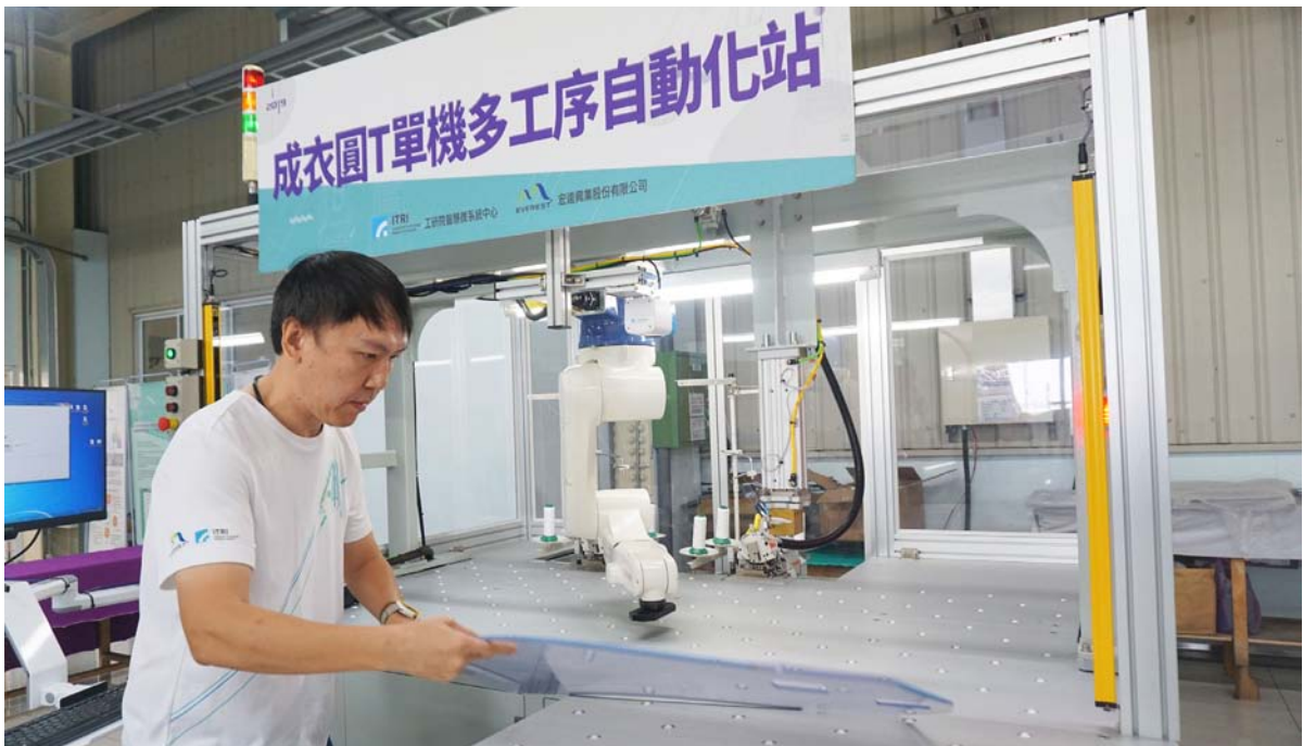
與工研院合作的「成衣圓T單機多工序自動化站」，以6軸機械手臂結合視覺感測器，將原本多工序的車縫作業整合為一站式完成，促使臺灣成衣業邁向半自動化。
