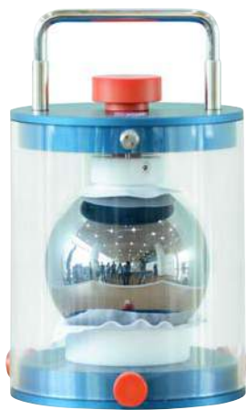
這類實現公斤新定義的矽晶球，為直徑93.7mm、矽28純度超過99.99%的完美球體。
