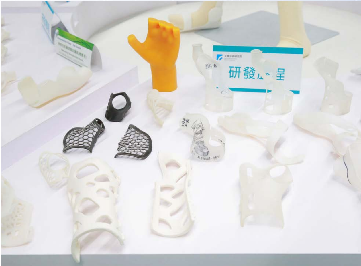
透過「3D列印設計服務共創平台」，設計並列印出個人專屬的輔護具，具有精準貼身、舒適及結構輕量化的優點。
