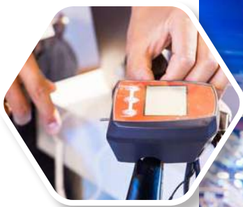
多功能車表可顯示騎乘速度、電量、時間，以及輔助動力的切換，讓騎車輕鬆。
