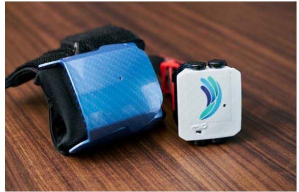
酷手科技研發的肌肉活動訊號感測技術靠著肌肉訊號與手指動作，其辨識精準度可達96~97%。
