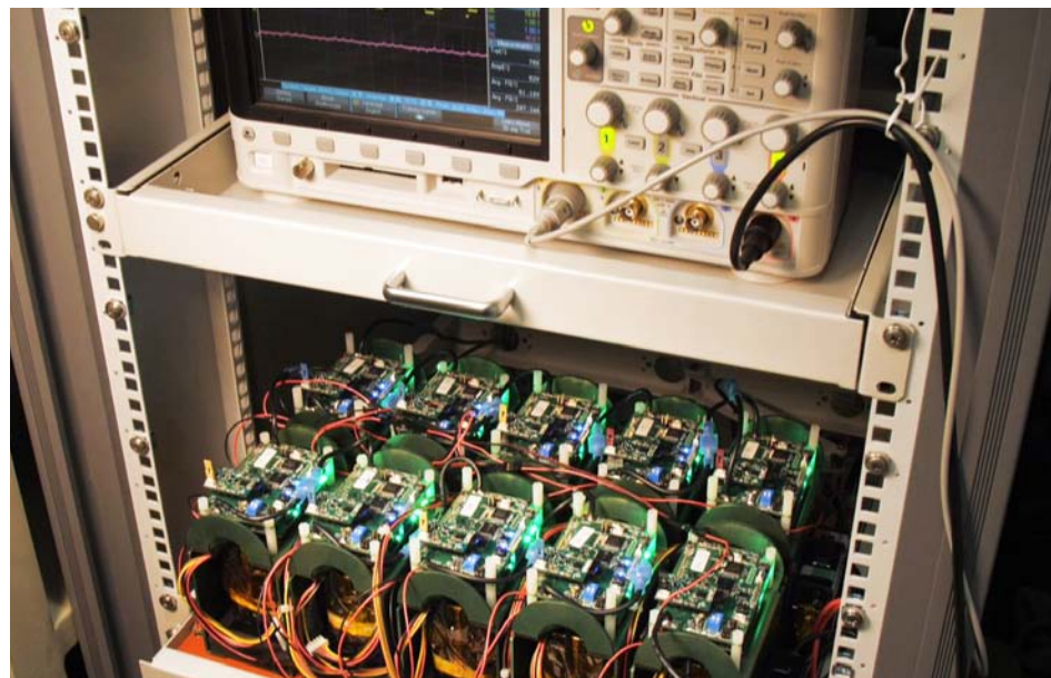
「可線上即時重組電池陣列技術」讓不同電池模組以有效率的方式互相搭配，得以延長系統運轉的時間。
